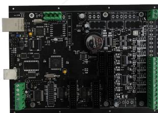
CPU per gestione di messaggi prememorizzati (fissi o scorrevoli e BMP) richiamabili dalla chiusura del contatto NA (Normalmente Aperto), impostabile sia per contatti fisici che contatti con codifica BCD (Binary-Coded Decimal).
